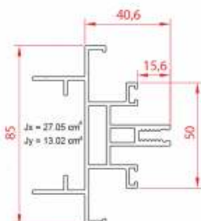
5109 پروفیل افقی Transom Profile 1.746(kg/m)
